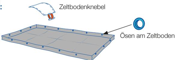
GentleTent bietet für die GT-HOME und GT-BOX Modelle einen optionalen Zeltboden an. Der GT ZELTBODEN wird mit den Ösen und den am Zelt angebrachten Zeltknebel befestigt.
