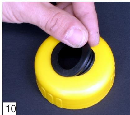
10/ Durchführungsgummi in die Bohrung einsetzen
