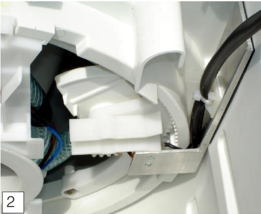
Der Aluminiumwinkel muss so eingeklebt werden, dass die Gleitrolle (3) des Mikroschalters an der hinteren Kante des Schieberöffnungsriegels anliegt. HINWEIS: Bei gedrücktem Schalter ist die Stromzufuhr unterbrochen, so dass nur bei geöffnetem Schieber der Lüfter eingeschaltet wird.
