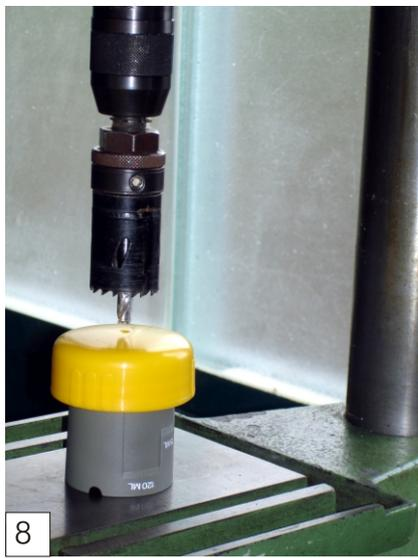
Um den Schlauchanschluss an der Cassette herzustellen muss der Schraubdeckel am Ausgussrohr aufgebohrt werden.
