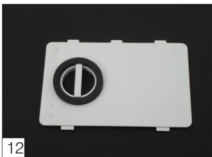
12/ Einlegeplatte im Servicefach entfernen (ins Fahrzeug legen zu den Kundenunterlagen). Über den mittleren Steg in der Bohrung wird das Entlüftungsventil in der Cassette geöffnet.
