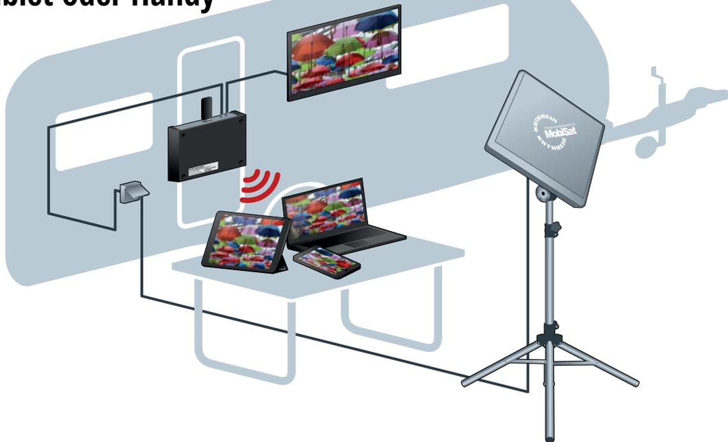
Abb. 10: Live-TV auf mobilen Endgeräten mit HDS 166 plus
